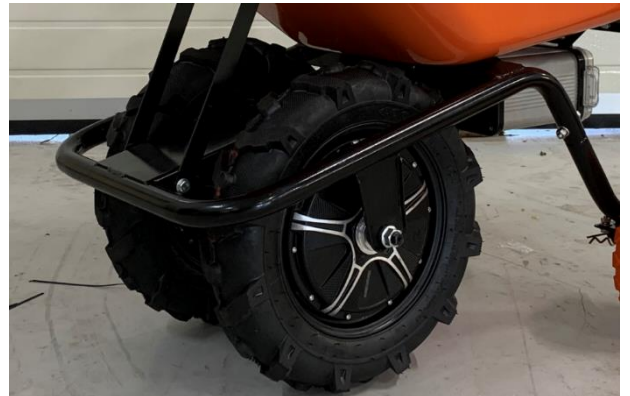
EBS og BAS bremsen ligger på innsiden av de elektriske motorene.
